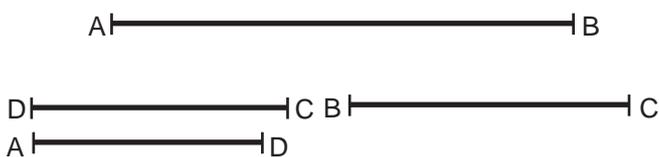
Sobre la base AB dada traza un trapecio escaleno dadas sus bases (AB y DC) y sus diagonales (AC y BD):
